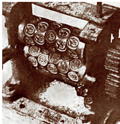
Billedet illustrerer, hvordan de enkelte stempler er skåret forskudt ind i valsen for både at udnytte pladsen bedst muligt og give den bedste trykfordeling ved overførslen til mønttenen.
